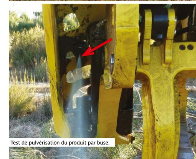
Test de pulvérisation du produit par buse.
